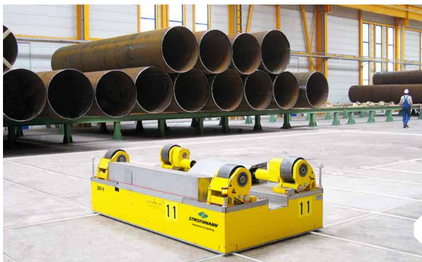
Fahrerloses Transportsystem seit 15 Jahren in Betrieb
